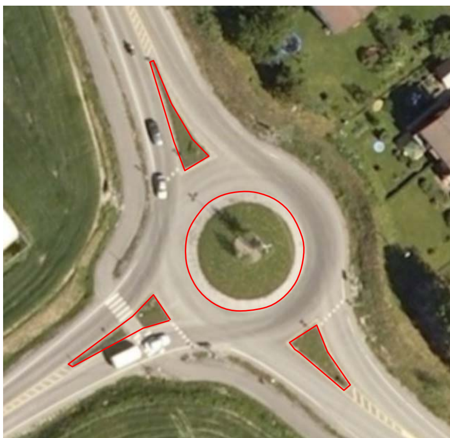
Figur 14: Eksempel på trafikkøye. Trafikkøykant er tegnet med rød strek. Det presiseres at trafikkøykant skal registreres ut til kantstein. I dette eksemplet er det et steinsatt område på innsiden av kantsteinen. Dette området skal ikke registreres.
