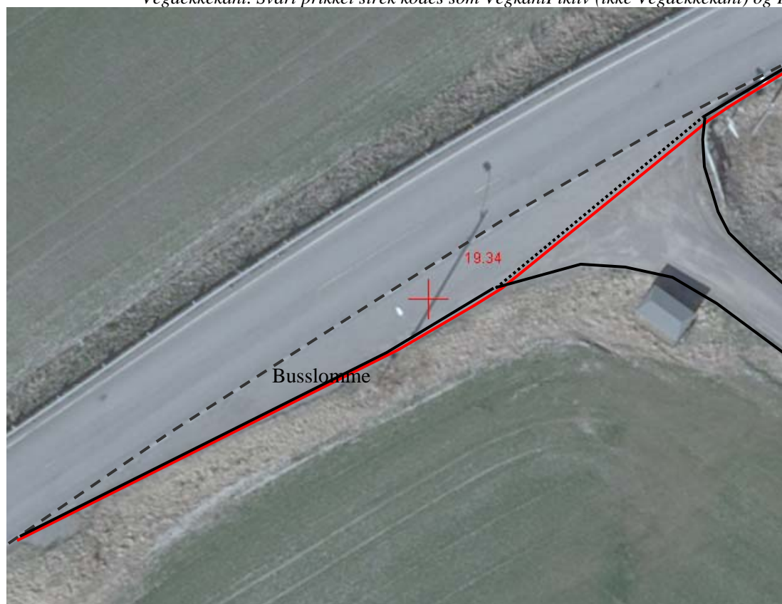
Figur 25: Eksempel på registrering av busslonne ved vegkryss. Grå stiplet strek er Kjørebane kant. Svart strek er Vegdekke kant. Rød strek er Vegskulder kant. Svart prikket strek er VegkantFiktiv.
