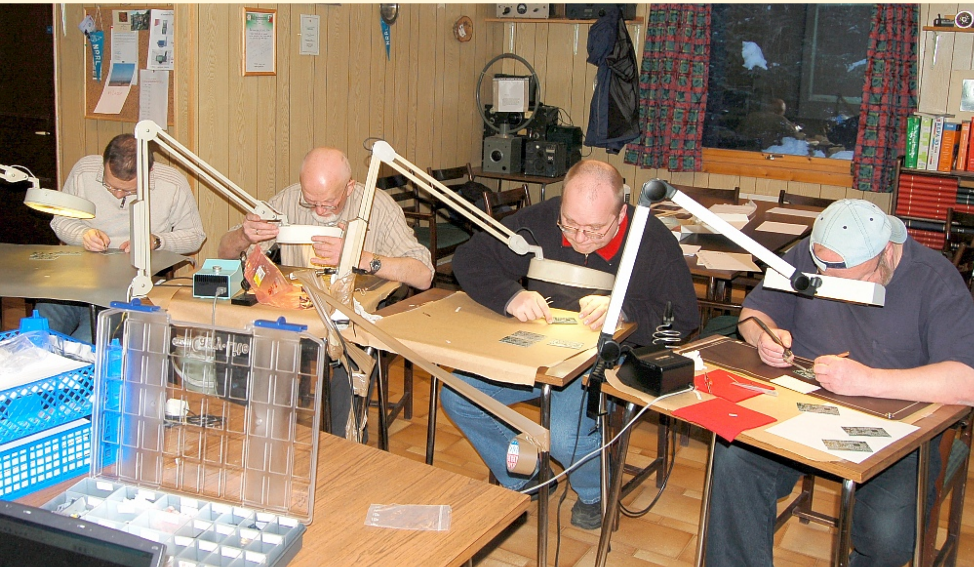
LA9SDA (Dag Kjetil), LA2NI (Kjell), undertegnede og LA4DEA(Torfinn) monterer komponenter på 16 kretskort Foto: LA7QM (Arvid Andreassen)
